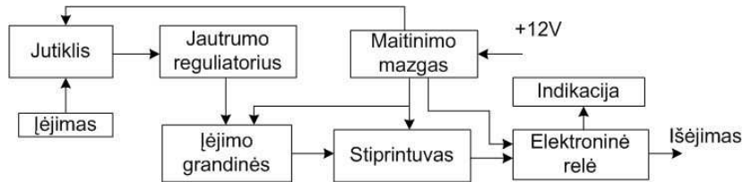
4.3 pav. Elektroninės termo relės sandaros schema
